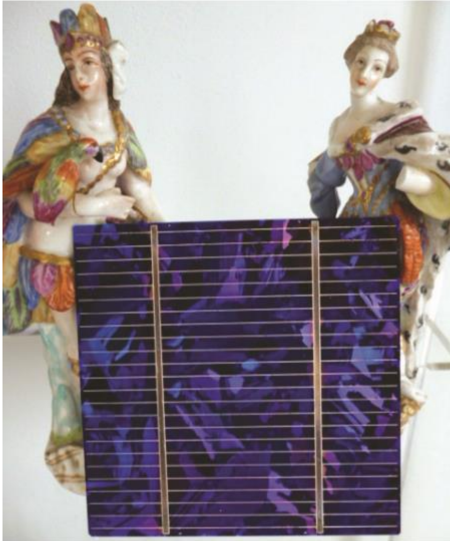
Figure 6.1 Une cellule solaire au silicium multicristallin (photo de l'auteur).
